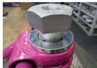
Abb. 8: Sprengring umlaufend vertieft in der Ansenkung positioniert
