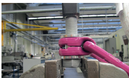
Abb. 6: Auflage des ICE-LBG-SR zur Demontage der Schraube
